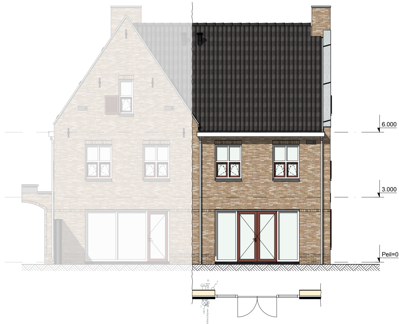
Basistekening Poortwoning Achtergevel | Optie dubbele openslaande deuren
