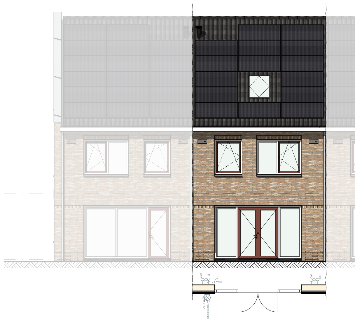
Basistekening Koetswoning Achtergevel | Optie dubbele openslaande deuren
